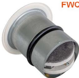
**FWC-EIS- ...** Valvole di ventilazione con cartuccia tagliafuoco con chiusura automatica comandata tramite fusibile bimetallico tarato a 72°C.
