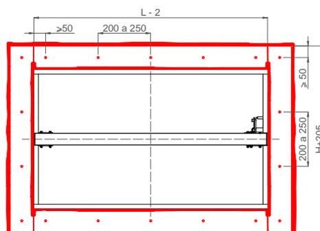
Sección del sellado compuerta (lado opuesto al dispositivo de accionamiento)
