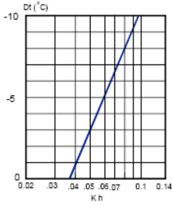
Kh – Поправочный коэффициент при вертикальной диффузии
