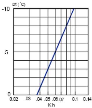
Kh – Поправочный коэффициент при вертикальной диффузии
