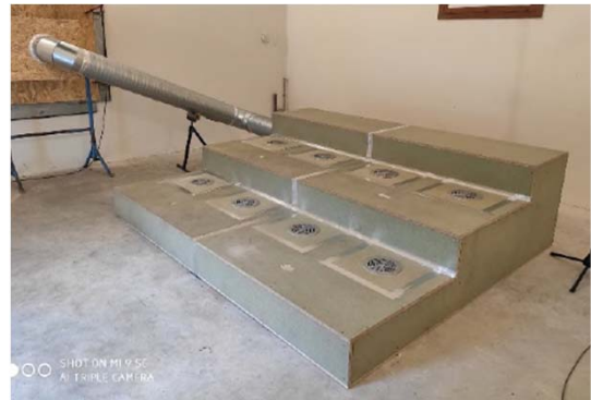
Figura 2 Modelo de gradas con 8 difusores
