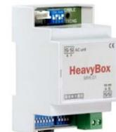
**KBY:** Modulo di controllo della pressione KBY (range 50-300 Pa) per la regolazione della pressione costante nel plenum di mandata. Taratura della pressione tramite selettore rotativo. Possibilità di intervento su ventilatori EC.. Richiede serranda motorizzata di by-pass ZC.
