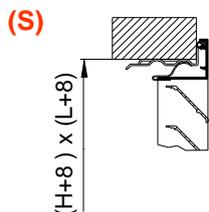
**(S)** La fixation se fait par clips. Ce système nécessite du cadre de montage CM.
