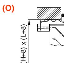
**(O)** La fixation se fait au moyen d'une vis cachée. Ce système nécessite du cadre de montage CM.
