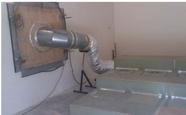
Figura 1 Collegamento del condotto dell'aria ai supporti
