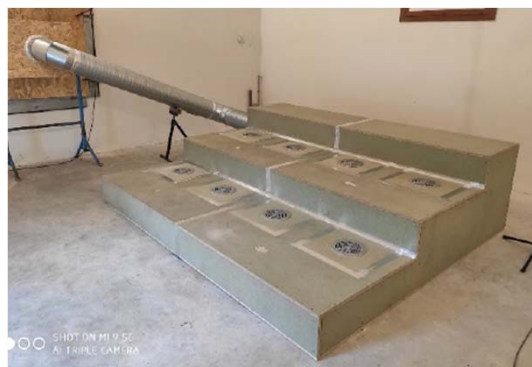
Figura 2 Modello di supporti con 8 diffusori
