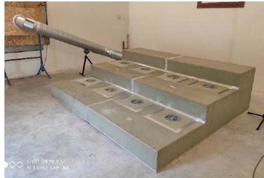
Figure 2 Maquette des gradins avec 8 diffuseurs
