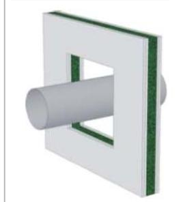
3. Applicare il rivestimento antifluoco sul canale stendendolo anche su 70 mm su ogni lato rispetto al muro.
