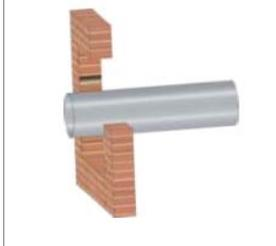
3. Tamponare il vano e coprire il canale con rivestimento antifluoco
