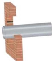
3. Remplir le creux et couvrir le conduit avec un recouvrement coupe-feu
