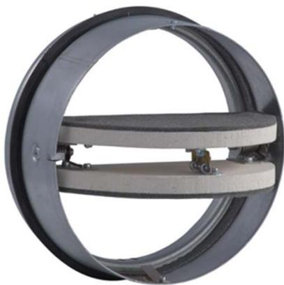
Fourn. et mise en place de cartouche coupe-feu à installer à l'intérieur d'un conduit circulaire de ventilation / climatisation, classée EIS 120 selon la norme *EN 13501-3* et avec une certification CE selon la norme *EN 15650*, de la série **FSC-EIS-120-CIF/ diam. 200**.
