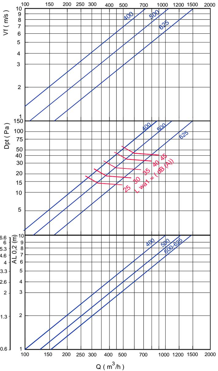
SECCION LIBRE DE SALIDA DEL AIRE (m<sup>2</sup>).
