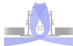
Flux d'air alterné dans 2 directions. Pour une plus grande induction et contrôle de l'air.
