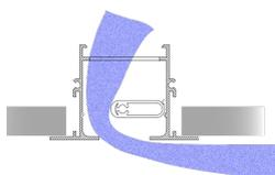
Flux d'air dans 1 direction (orientable droite - gauche)
